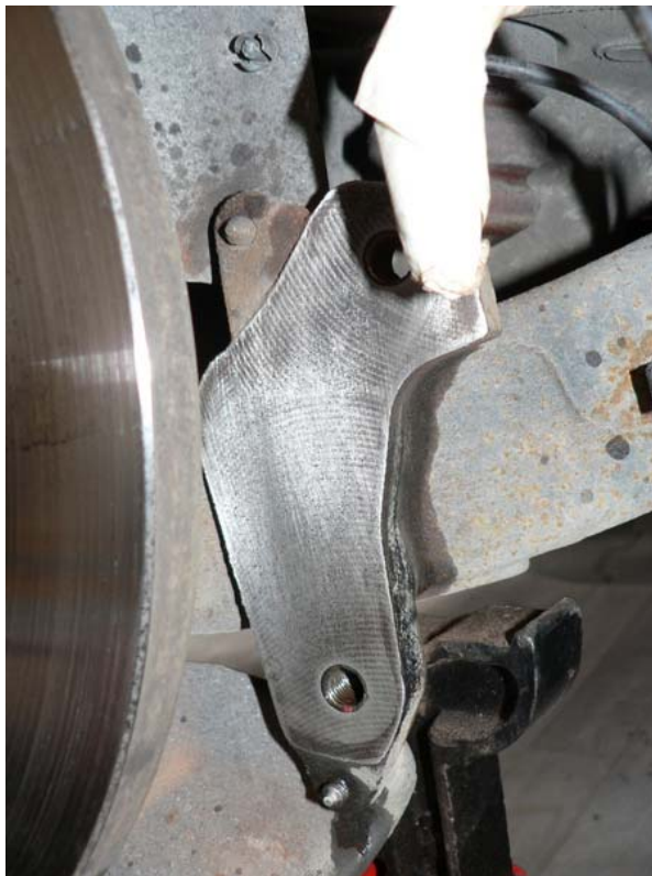
idem pour le bras de suspension un petit coup de toile émeri et le support retrouve un aspect plus convenable
