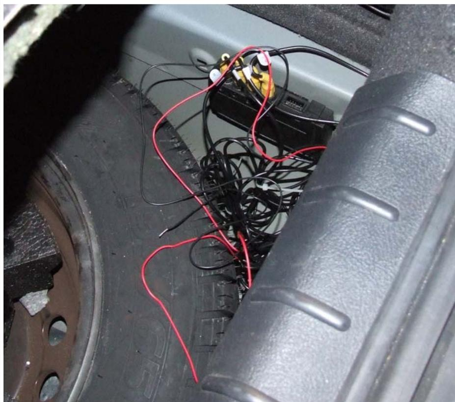
8 - Envoyer les câbles rouges et noirs vers le feu arrière droit (par dessous la moquette ou par dessus (pour les essais j'ai mis par dessus)
