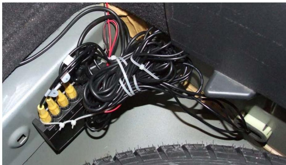
12 - Si on ne veut pas mettre l'écran devant sur le tableau de bord, on le fixe dans l'habitacle roue de secours, on ne verra pas les petites lumières de Noël ...mais on entend les bips .. comme le radar d'origine d'ailleurs ! Cela a 2 avantages : on n'a pas de câble à passer vers l'avant ! On n'encombre pas le tableau de bord ! Et un inconvénient : on ne localise pas à droite ou à gauche l'éventuel obstacle.
