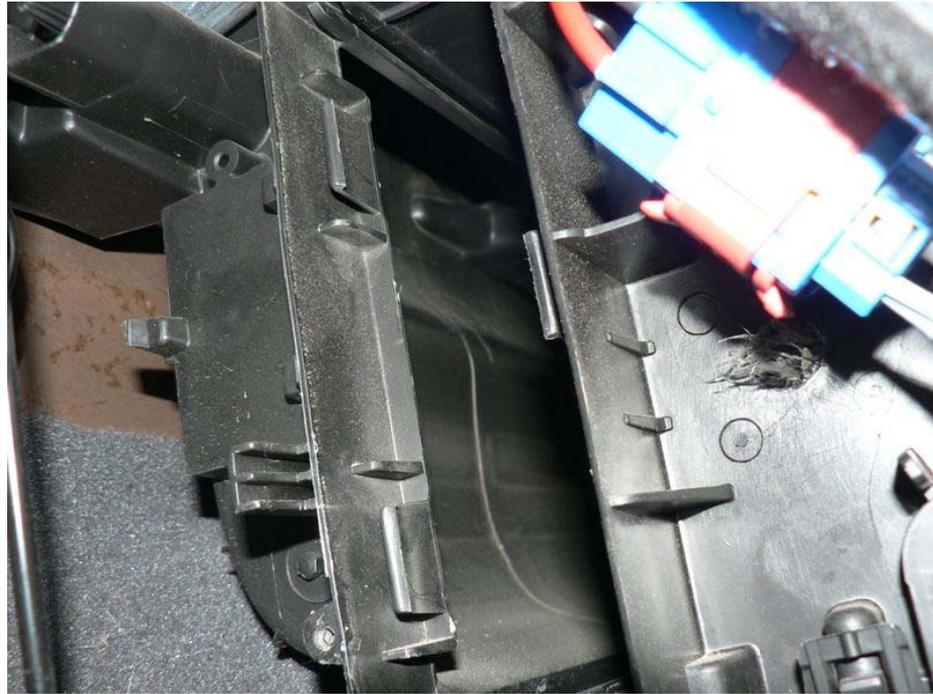
Pour le remettre, c'est un peu compliqué bien que le cadre du filtre soit découpé de manière à ce qu'on puisse le tordre quelque peu pour pouvoir le rentrer. Tout se passe derrière le filtre, il faut que la patte du filtre (flèche bleue) passe sous le renfort du porte filtre (flèche rouge) sinon ça ne rentre pas
