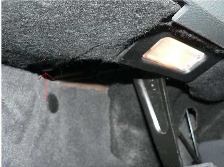
Du côté droit, l'habillage est simplement maintenu par un clips. Celui ci se trouve derrière l'habillage gris clair au niveau du carré blanc sur la photo. Il suffit de tirer cet habillage pour voir le clips
