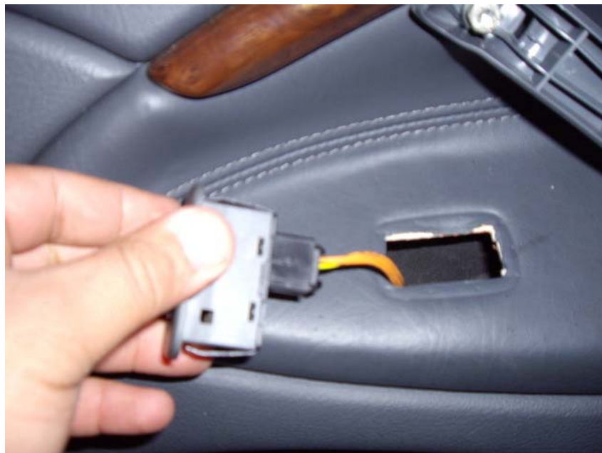
7- Oter le cache enceinte à l'aide d'un levier (tournevis plat, couteau de cuisine)
