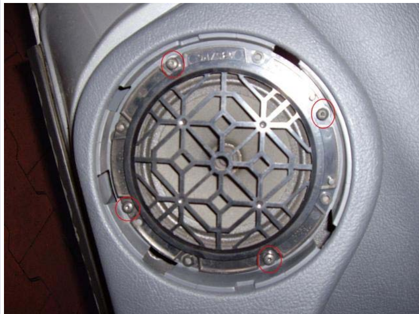
9- Dévisser les vis de maintien du panneau de porte enfouis dans deux tunnels à l'aide du même tournevis torx
