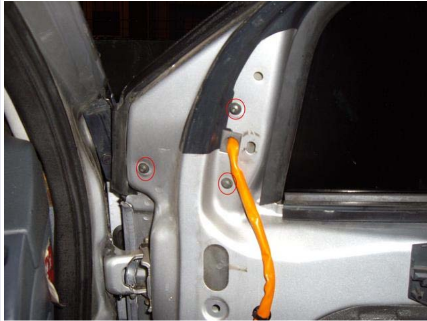
13- Retirer la prise jack d'alimentation de la commande de rétro électrique située sous le moteur de lève-vitre
