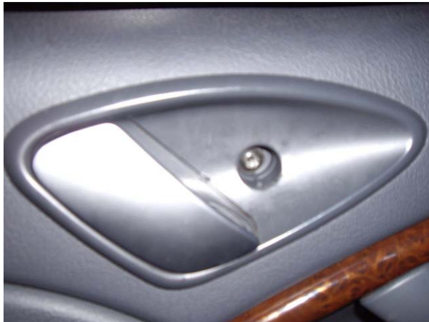
3- Dévisser la vis de maintien du cache-poignée
