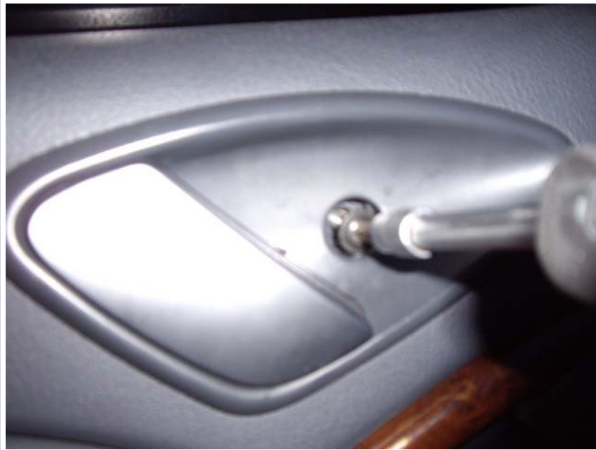
4- Exercer une pression extérieure pour extraire le cache-poignée
