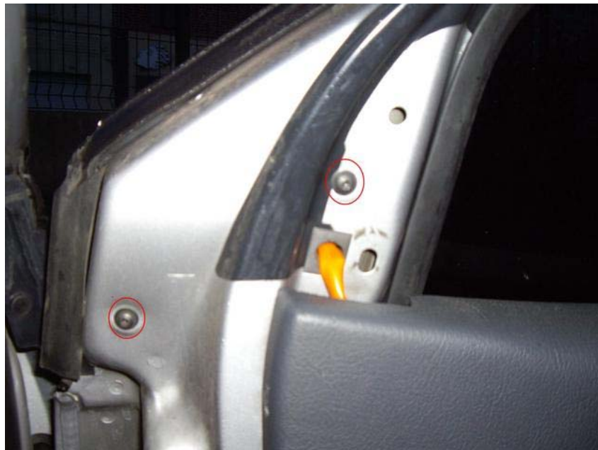
2- Retirer le cache plastique recouvrant la vis de maintien du cache-poignée
