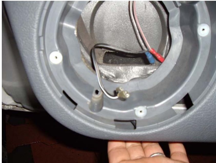
12- A présent on arrive à distinguer les 3 vis de maintien du rétroviseur que l'on peut dévisser toujours à l'aide du même tournevis torx (bien pratique celui là : investissement rentabilisé)
