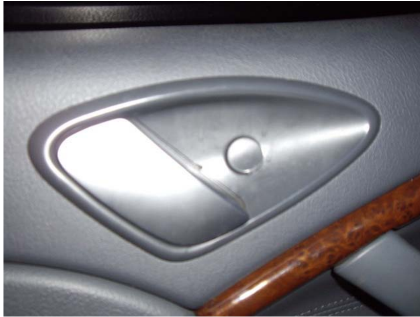
3- Dévisser la vis de maintien du cache-poignée
