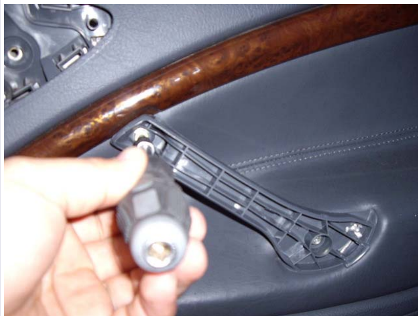
6- Extraire la commande de lève-vitre et l'oter en prenant soin d'enlever la prise jack
