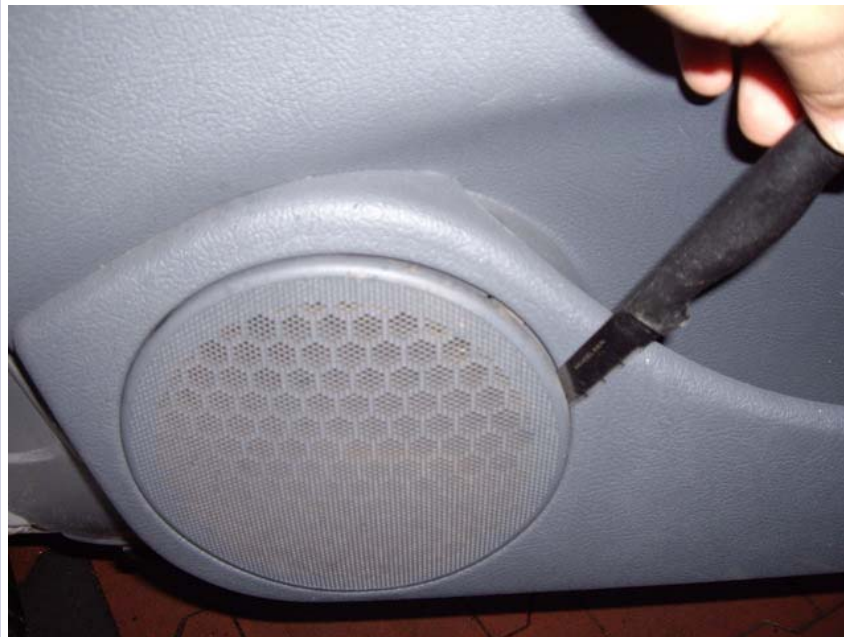
8- Dévisser les vis de maintien de l'enceinte à l'aide d'un tournevis torx (voir les cercles rouges)
