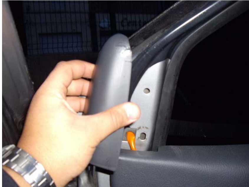
On voit apparaître 2 des 3 vis de maintien du rétroviseur (cerclés en rouge)
