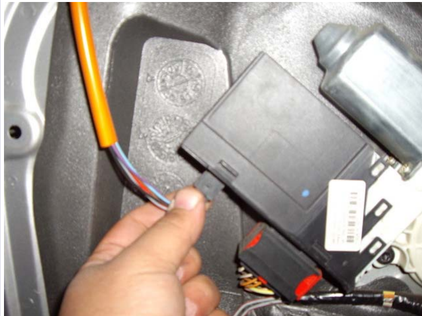
14- Retirer le clip de fixation muni d'un colson pour maintenir le cable d'alimentation du rétro
