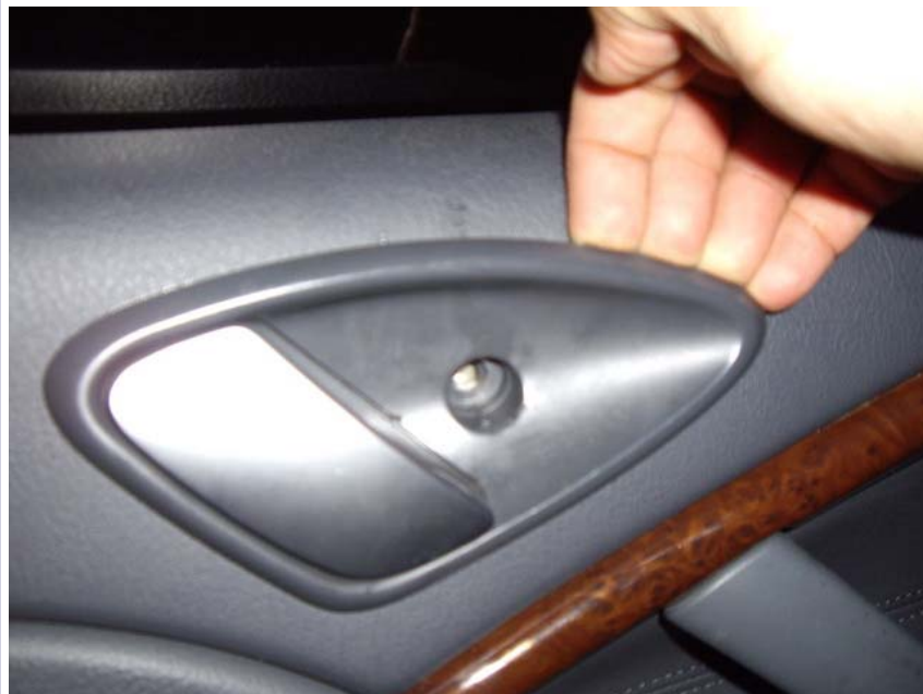
5- Oter le couvre-poignée de rabattement de porte pour laisser apparaitre les vis de maintien et les dévisser
