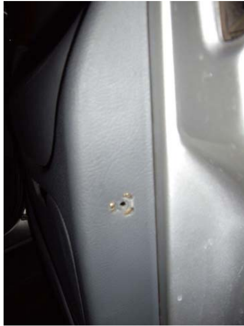
11- Tirer fermement sur le panneau de porte (plus facile au niveau de l'emplacement de l'enceinte) afin de faire sauter les clips et pouvoir le retirer
